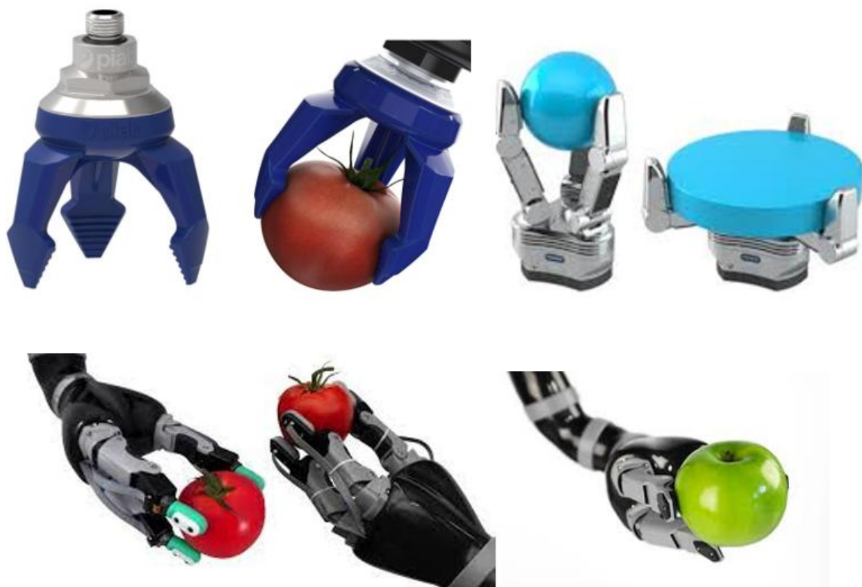
Рисунок 3.2 - Виды трехфаланговых схватов роботов
