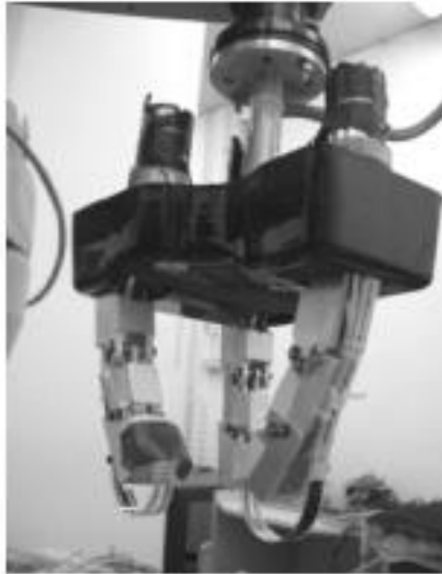
Рисунок 5.1 - Роботизированная рука с трехфаланговым схватом с адаптивным приводом для экспериментальных испытаний упаковки помидоров
